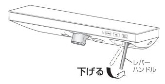
・停電が復旧するまでは、レバーハンドルの操作(3.↔ 4.)で、水の出し止めを行います。
