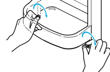
水受けストッパー固定ネジ(2本)を手で確実に止めてください。
