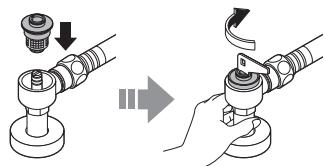
7 止水栓または元栓を開けて、止水栓カバーを取り付ける
