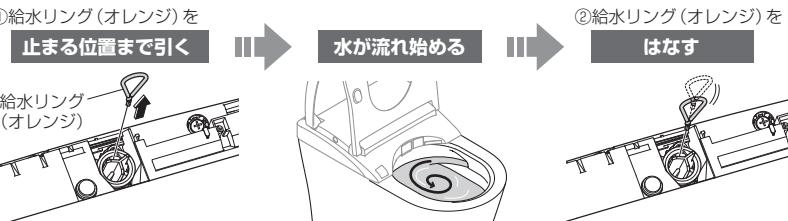
4 水ためリング(白)を操作して、便器の水たまり面を上昇させ、便器の水を流す
