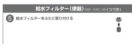
給水フィルターのふたをもとの位置に 取り付け、開閉工具で締め付ける
