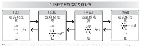
温度調節ランプは、約10秒以上ボタンを押さない時間が続くと、設定を記憶したまま消灯します。設定の途中で温度調節ランプが消灯したときは、手順1からやり直してください。
