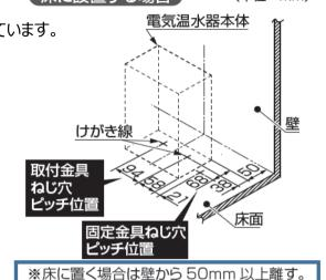
※ タンク水抜き作業考慮のため、電気温水器本体の底面は床から30mm以上を確保ください。
