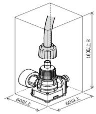
※膨張水処理継手の高さ+スパウト連結ホース が接続できる寸法
