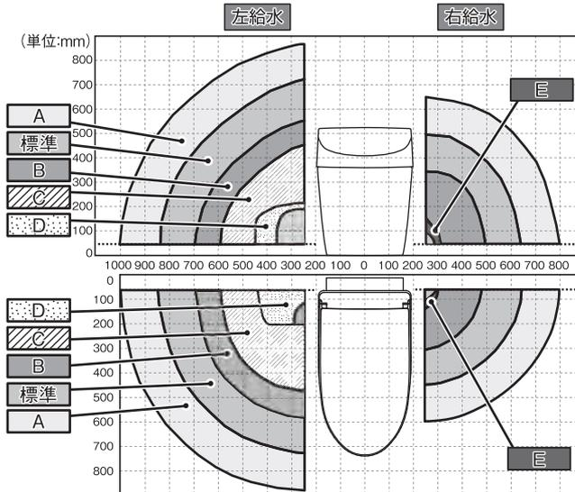
※給水ホースが折れないように接続方向を調整してください。
