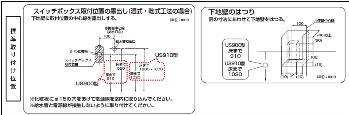
★スイッチボックスは、小便器バックハンガーや固定片、給水管などと干渉しない位置に取り付けてください。
