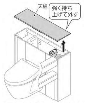
※天板はキャビネットに強力に固定されています。壁のクロスなどに十分気をつけながら取り外してください。
