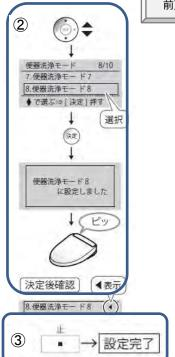
新しいリモコンで作動確認を行う ※連続して流すボタンを押しても作動しません。 約10秒たってから、もう一度ボタンを 押してください
