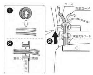
❸ 電源コード、給水ホースはスタンドの下側、接続管の 上側を通し、キャビネットの右側より引っ張り出す
