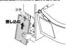
② 点検口下部の手掛けを持ち、点検口「上部」 と「手前」を側板・前板に押し当てながら キャビネットの金具に差し込む
