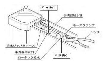
⑤手洗器を後壁に固定しているねじ、および手洗器と支持材を 固定している化粧ねじを外す。
