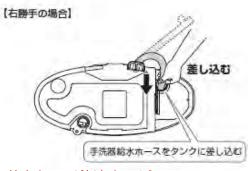
※給水ホースが折れないように 注意してください。 天板を固定しているねじを外し、天板を持ち上げる
