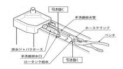
⑤手洗器を後壁に固定しているねじ、および手洗器と支持材を 固定している化粧ねじを外す。
