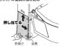
高検口と側板、前板との段差がなくなるように下部を押し込む
