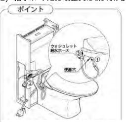
ウォシュレット給水ホースは便器穴を通し、先に 分岐金具に接続し、その後ウォシュレットに 接続する。
