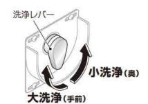
3 洗浄レバー補助カバーを 取り付ける
