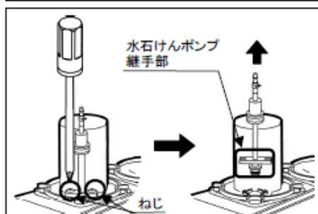
③新しい逆止弁を水石けんポンプに差し込み、ねじ（2ヶ所）を止めます。
