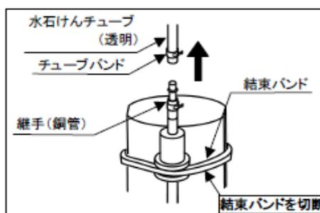
②逆止弁下方のねじ（2本）を取り外し、水石けんポンプの継手部ごと逆止弁を引き抜きます。
