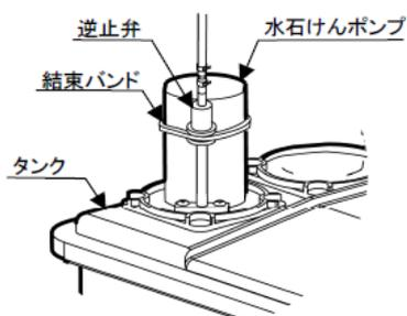
①チューブバンドを上方へずらし、水石けんチューブ（透明）を継手（銅管）から取り外す。また、逆止弁を水石けんポンプのモータ部に縛りつけている結束バンドを切断除去する。
