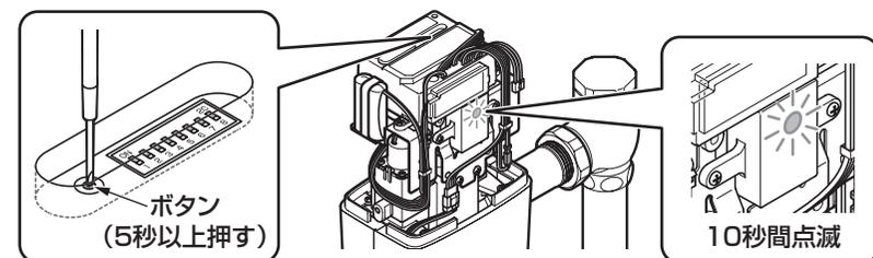
故障などの理由により、リモコンスイッチを取り替える場合は一度、同期を全消去してください。その後、新しいリモコンで同期作業を行なってください。
