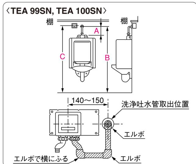
なお、US-A型 (埋込型) を標準位置より下げて取り付ける場合は、洗浄管の横にセットされることとなります。そのさい、給水配管は上図のように斜線部に常時、水がたまることとなりますので、施工時には必ずこの部分から漏水しないかどうか十分な確認が必要です。
