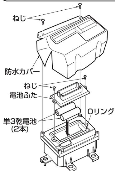
1. 2本のねじをゆるめて、コントローラーにかぶせている防水カバーを外す。
