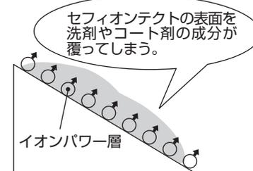
※セフィオンテクトとは、新開発の釉薬で陶器表面の凹凸を100万分の1mmのナノレベルでツルツルにします。また、イオンパワーで汚れの付着力を弱めるTOTO独自の技術です。
