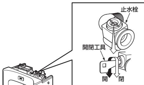
・開閉工具で止水栓を閉める。
