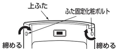
4. ふた固定化粧ボルトを向かって右へ回して締めて、上ふたを固定する。
