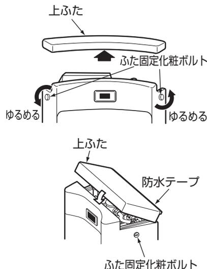
1. 六角棒レンチで左右側面にある、ふた固定化粧ボルトを向かって左へ回してゆるめる。
